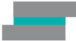
Eine Klebedichtung ist in diesem Fall (siehe Abbildung) erforderlich. Die Dichtung wird durch die Adhäsionskräfte zwischen dem Dichtungsmittel und den zwei Teilen hervorgerufen, die zusammengefügt werden. Das Dichtungsmittel bildet eine Barriere, welche die gewünschte Abdichtung bewirkt.
