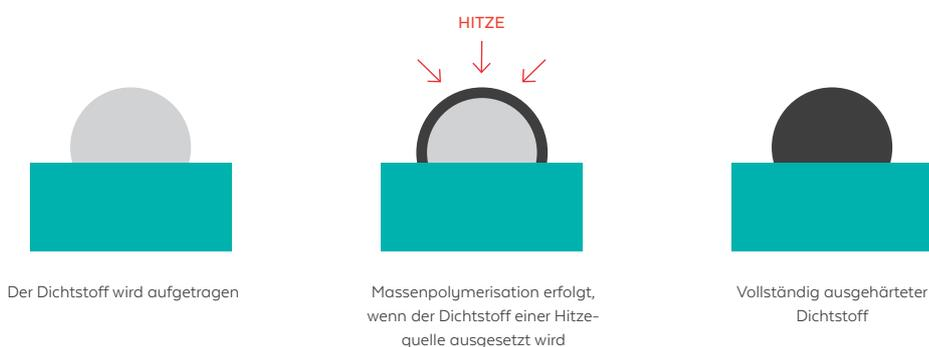
Einkomponenten-HTV-Silikone können manuell oder maschinell aufgetragen werden. Die Bauteile müssen vor der Wärmehärtung gefügt werden. Die entstandene Baugruppe darf während der Aushärtung im
