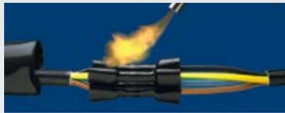
Die mit Heißschmelzkleber beschichteten Innenmuffen werden über die Verbinder geschoben und aufgeschwumpft. Dabei schmilzt der Kleber und gewährleistet eine zuverlässige Abdichtung gegen das Eindringen von Wasser.
