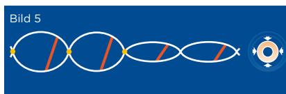
Wird der Schlauch bei der Verarbeitung erwärmt, lösen sich die kristallinen Zonen. Die Vernetzungskraft schrumpft den Schlauch auf seinen ursprünglichen Durchmesser (Bild 5). Dieser Effekt wird auch als „elastisches Formgedächtnis“ bezeichnet.
