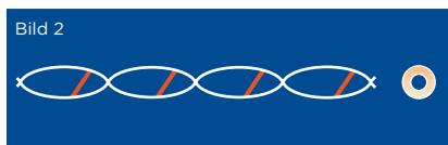
Bei Erwärmung über +120 °C werden die kristallinen Zonen aufgelöst (Bild 2). In diesem Zustand ist das Material elastisch und kann mechanisch expandiert werden.
