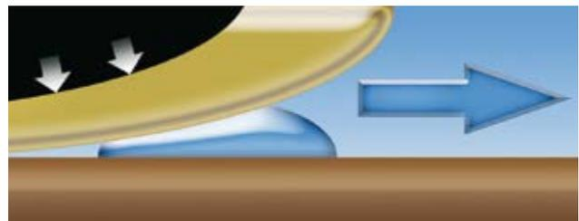
Bild 2 PowerGel - Verdrängung von Feuchtigkeit
