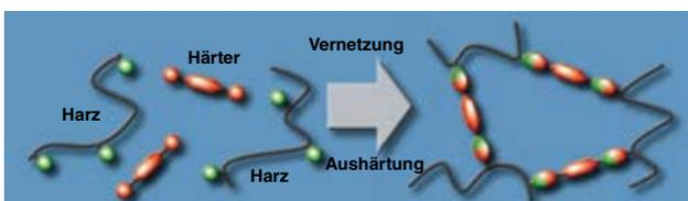
Bild 1 Schematische Darstellung der Reaktion bei Polyurethanen
