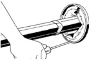
Abdichtmanschetten RDSS können nach Ablassen des Füllgases einfach und ohne Beschädigung der Kabel wieder entfernt werden. Der Austausch oder die nachträgliche Verlegung von Kabeln ist daher problemlos möglich. Durchführungen können immer wieder abgedichtet werden.
