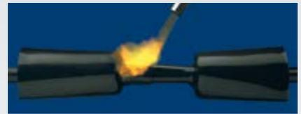
Zum Schluss wird die Außenmuffe positioniert und ebenfalls geschwumpft. Auch hier sorgt der Heißschmelzkleber für eine zuverlässige Abdichtung zwischen Außenmuffe und Kabelaußenmantel.
