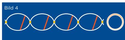
Beim Abkühlen des Schlauches in seiner expandierten Form unter +120 °C bilden sich die kristallinen Zonen zurück und fixieren den Schlauch in expandiertem Zustand (Bild 4). Diese Form ist die Lieferform wärmschrumpfender Materialien.
