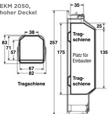
Positionsmöglichkeiten der Tragschiene
