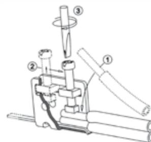
Bild 2 Montager Reihenfolge mit Schiebeklemmen
