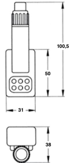
Kontaktblock B 6660 mit Stecksicherung B 6650 N
